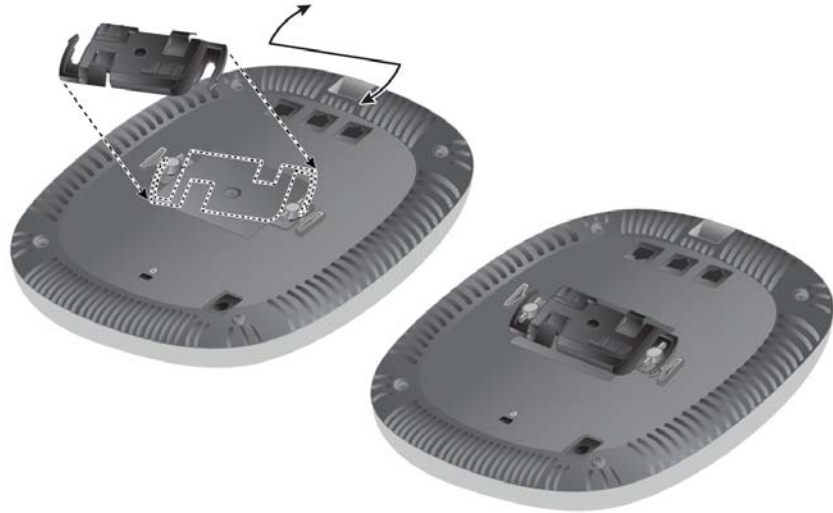
Gambar 7 Memasangkan Adaptor Rel Plafon
